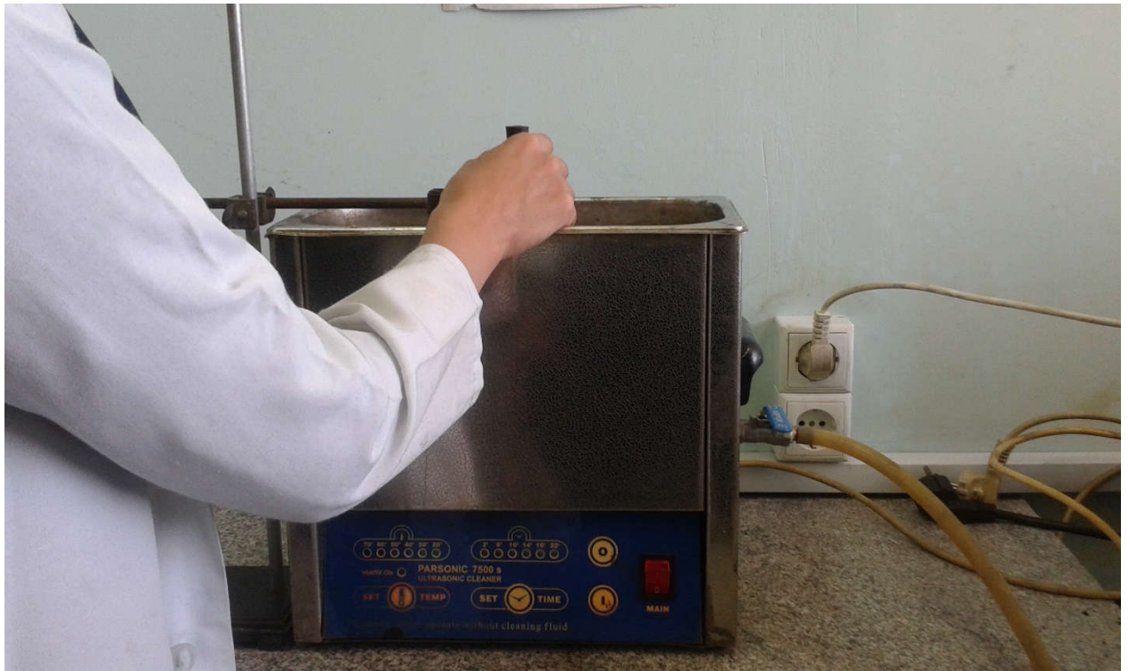
اولتراسونیک حمامی با توان ۱۰۰ وات و حجم ۶ لیتر برای پراکنش سریع نانوذرات
