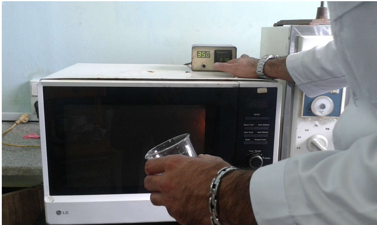
اجاق با کنترلر PID دما و قابلیت تغییر توان از ۳۰۰ تا ۹۰۰ وات
