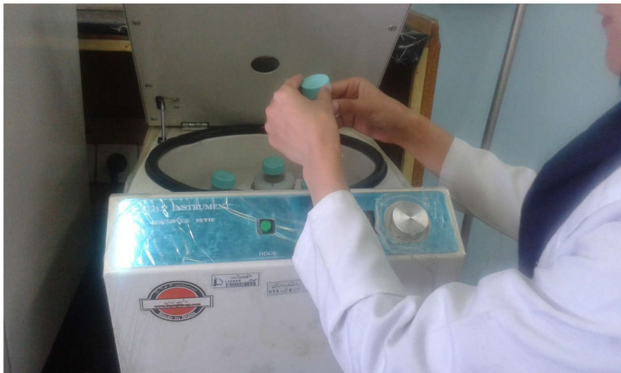
دستگاه سانتریفیوژ با سرعت چرخش بیشینه ۴۰۰۰ دور بر دقیقه برای جداسازی ذرات معلق
